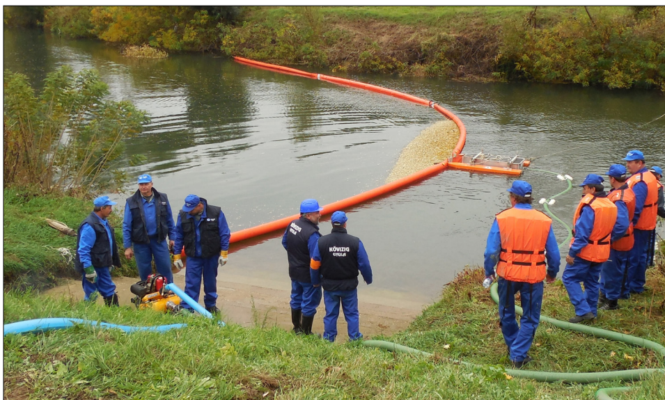
Olajszennyezést lefőlöző úszó merülőfal
