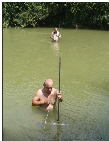
Vízhozammérés a Fehér-Körösön Kisjenőnél
