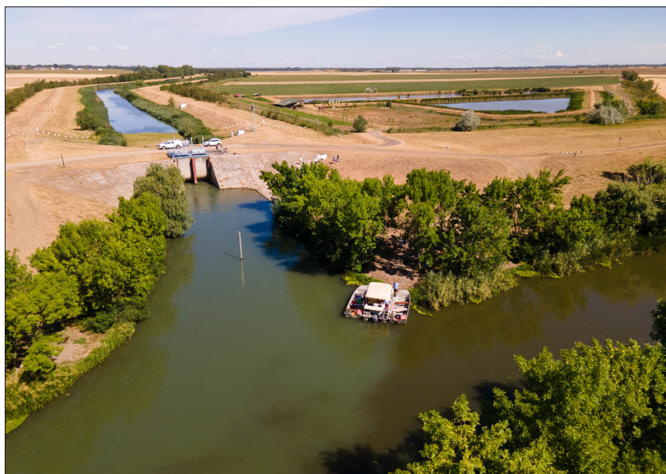
Az NK „25” fenékleürítő műtárgy és a beutazó vízijármű
