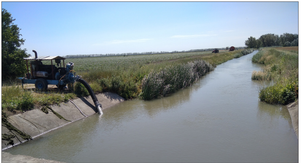
Víz kivételzés mobilszivattyúval, és csévélődobos öntözőberendezés a K-1 öntözőfőcsatornán
