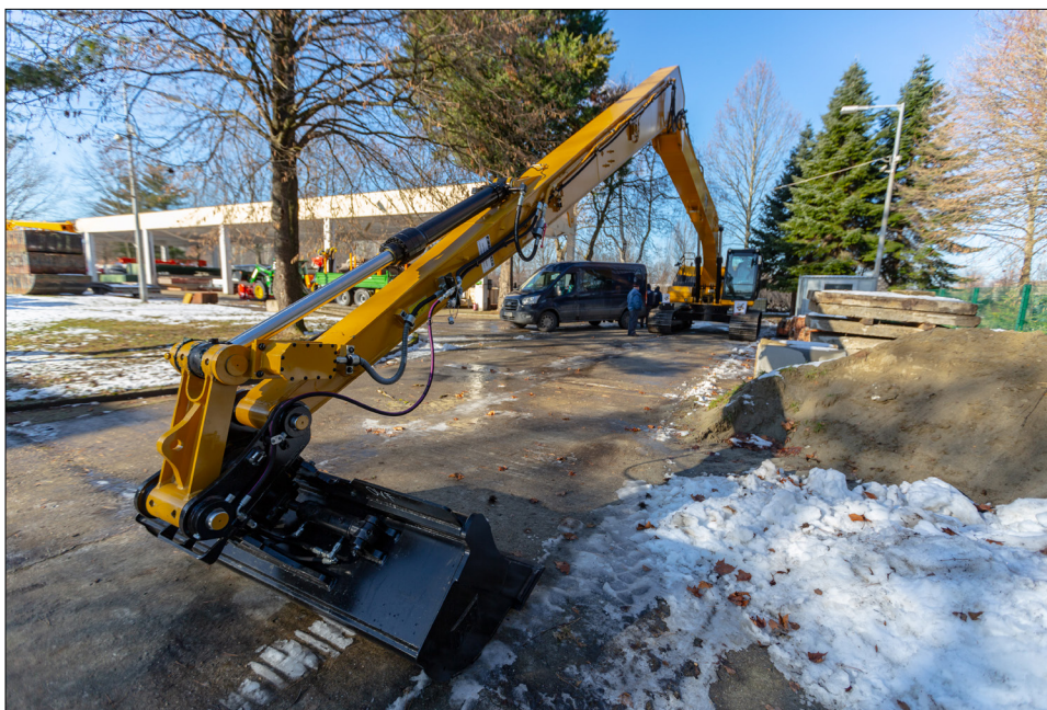
Az új CATERPILLAR 326 SLR típusú, nagy gémkinyúlású lánctalpas kotrógép
