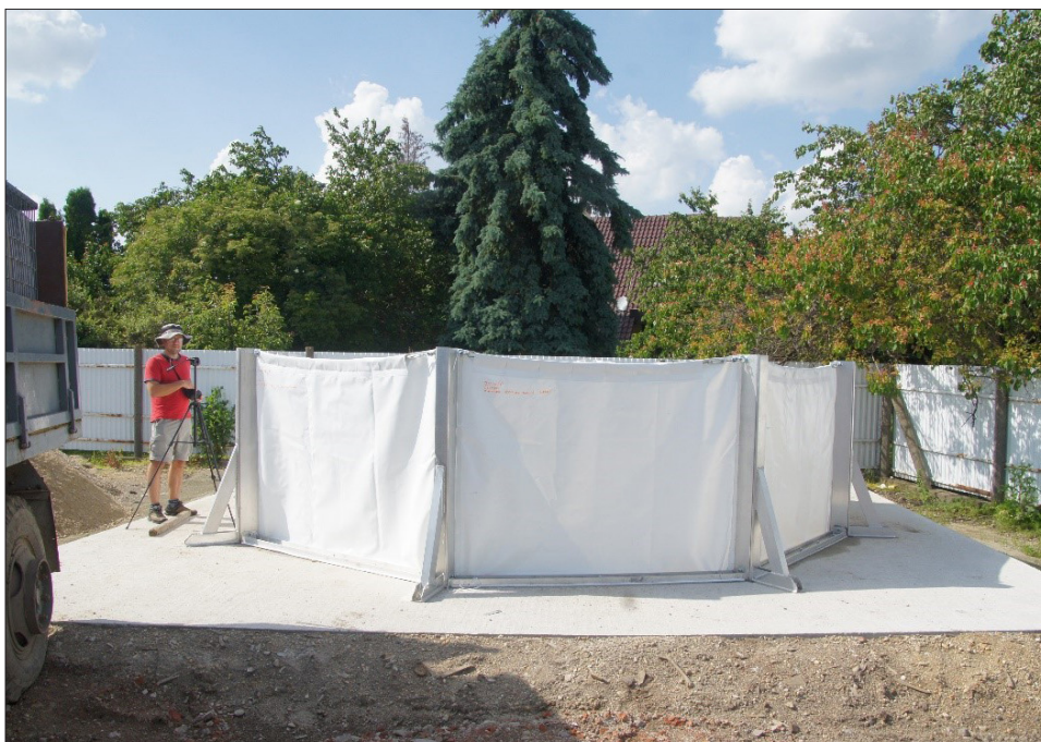
Nyolcszögletű medence vízzáróságának vizsgálata 2019.
