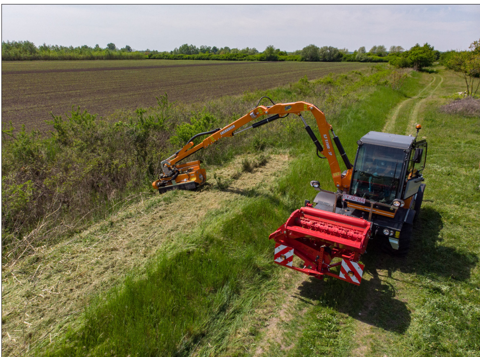
A csatornafenntartó gép munka közben
