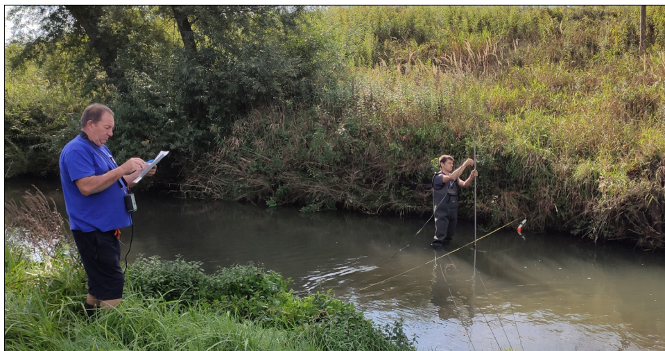
Mérés a Zala folyón forgószárnyas vízhozam mérő műszerrel
