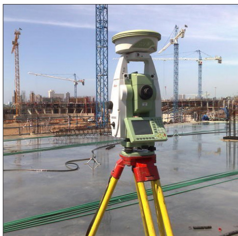
Leica mérőállomás és GPS vevő összeállítás (Leica)
