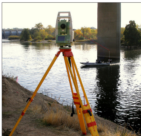
TotalStation (robot mérőállomás) mérőcsónakon lévő prizmára mér (Leica)
