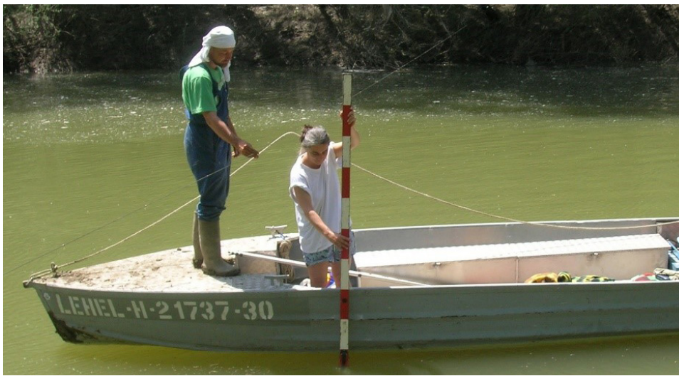
Hagyományos mederfelvétel szintezéssel, szondarúddal, beosztásos mércével, kötélre erősített ólom súllyal
