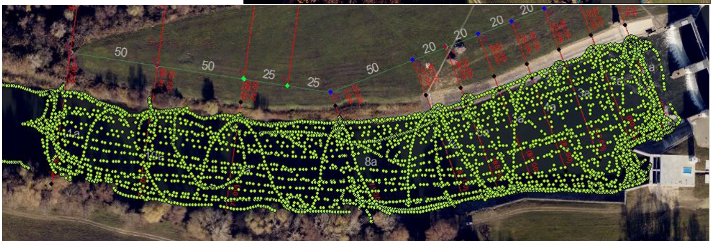
Pontosor és pontosorból képzett „pontfelhő”
