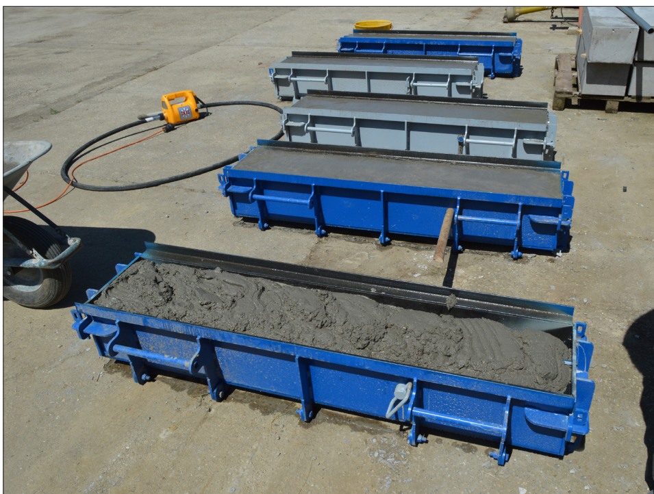
Acélsablonokban készülnek a szelvénykövek
