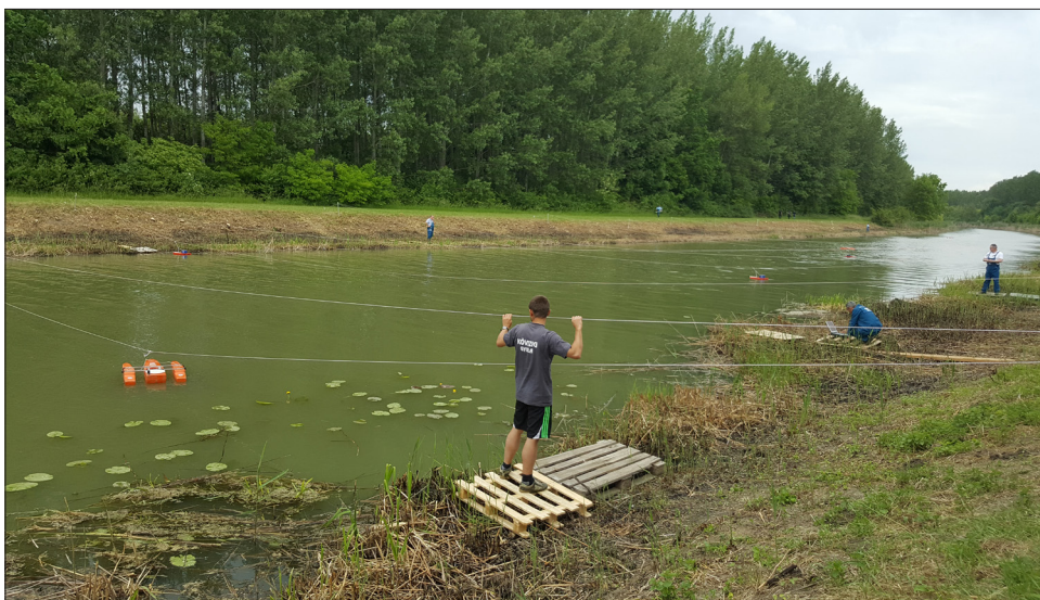
ADCP vízhozammérő műszer kalibrálása a Keleti-főcsatornán (Balmazújváros)
