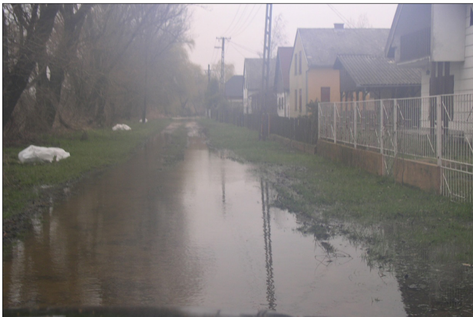
A Parti út elöntés alatt, a szennyvízcsatorna fedlapok lefóliázva és leterhelve
