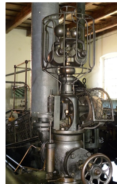
Láng gőzgép szabályozó szelepe
